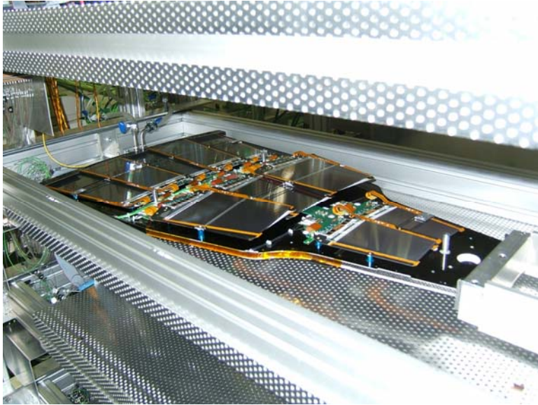
CMS : détecteurs sensibles et pétales d'un des bouchons du trajectographe
